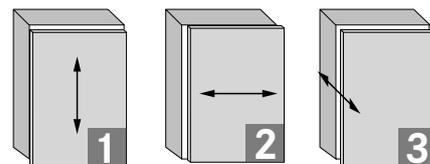
(HV) Regulación de altura +/- 2 mm
